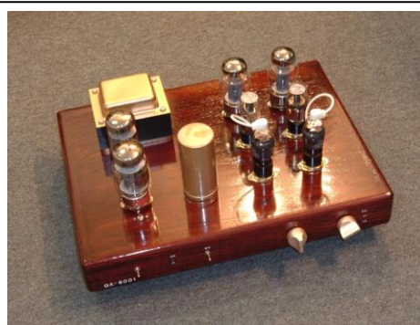
Ejemplo de amplificador que aún utiliza tubos de vacío en la fuente de poder. Los dos bulbos de la izquierda son los rectificadores. (Foto: Space-tech Labs).
