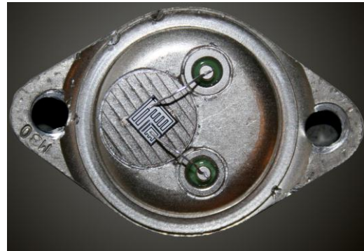
Casi cualquier dispositivo electrónico puede servir como fotodetector. Si se retira la tapa a un transistor metálico de potencia, su ganancia de corriente variará según la luz que llegue al chip. (Foto: Wikimedia).
