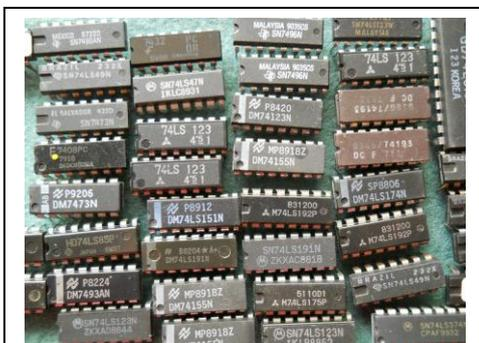
Los populares circuitos integrados TTL de la serie 74xx, están contruidos precisamente con base en transistores bipolares de juntura.
