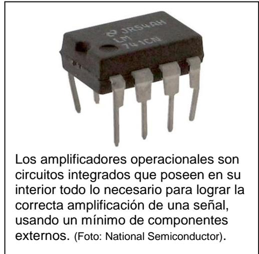
como un bloque funcional, donde quien esté diseñando un circuito sabe que por una de sus terminales entra una señal de cierta amplitud, y que por otra de sus terminales saldrá la misma señal amplificada las veces que sea necesario para su mejor aprovechamiento.
