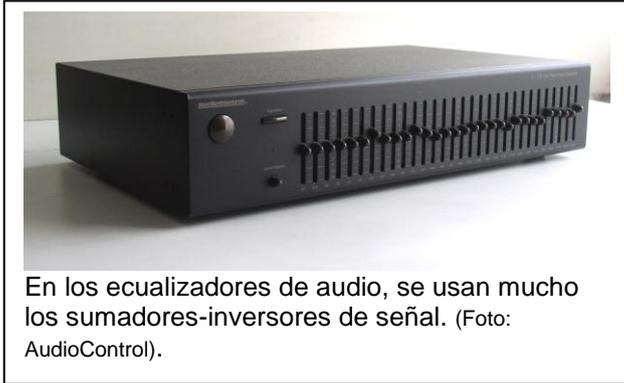
¿En dónde se usa un sumador-inversor? Un caso típico es en los equipos de audio que poseen ecualizador; en ellos, para poder modificar el grado de amplificación de ciertas frecuencias, se toma la señal total y se divide en una
