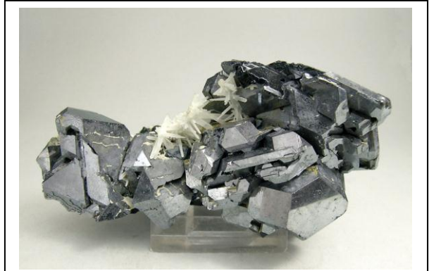
Las curiosas propiedades de la galena sirvieron para elaborar los primeros diodos rectificadores de cristal. (Foto: Fabre minerals).
