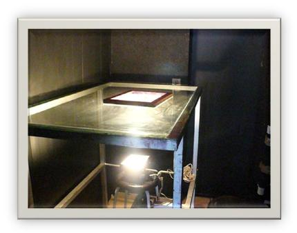
2. Una vez expuesta la malla en la mesa de luz procederá a revelarla con agua destapando las zonas pequeñas con atomizador o pistola de agua.
