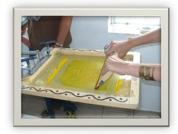
4. Posteriormente si el glitter está en polvo el estudiante esparcirá en la imagen que contenga termo gel y/o tinta kaltex. Retirando el exceso para no dejar una capa muy gruesa. Si ya está preparado se imprimirá como si fuera una tinta normal.
